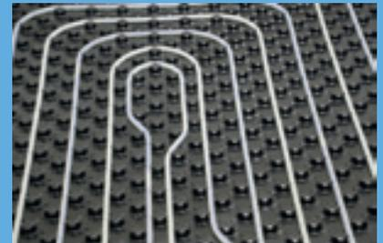
die speziell entwickelte noppenhinterschneidung der extrem stabilen tiefziehfolie erlaubt beim bavaria noppenfoliensystem den einsatz für rohrdimensionen 14x2 mm bis 17x2 mm und sorgt für perfekten halt in der noppenfolie.
