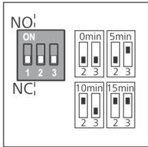
Die Einstellung des Wirksinns erfolgt mittels Jumper 1:
