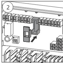
Abhängig von der eingelegten Sicherung (im Lieferumfang enthalten), kann die B 50302 an 24 V oder 230 V Spannungsquellen betrieben werden.
