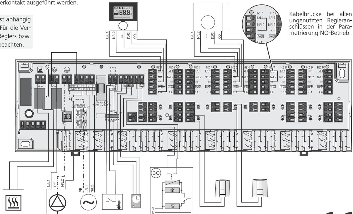
Kabelbrücke bei allen ungenutzten Regleranschlüssen in der Parametrierung NO-Betrieb.
