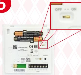
Batterien (im Lieferumfang enthalten) ins Batteriefach einsetzen und Raumthermostat einschalten
