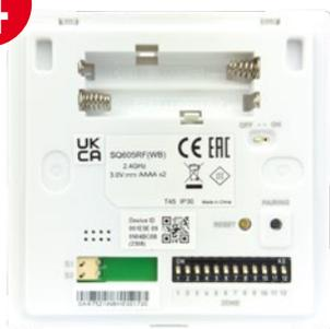
Batterien (im Lieferumfang enthalten) ins Batteriefach einsetzen und Raumthermostat einschalten. **Wichtig: Raumregler muss auf 5 °C stehen**
