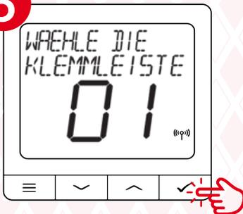
Verwenden Sie die ⏴ oder ⏵ Taste um die Nummer der Klemmleiste auszuwählen (drücken Sie die PAIR-Taste auf der Klemmleiste um die Adressnummer (Klemmplatz 1-8) anzuzeigen.). Drücken ✓ um diese zu bestätigen.
